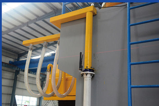
⑤ 冷却水自动开关装置 Recloser of cooling water
